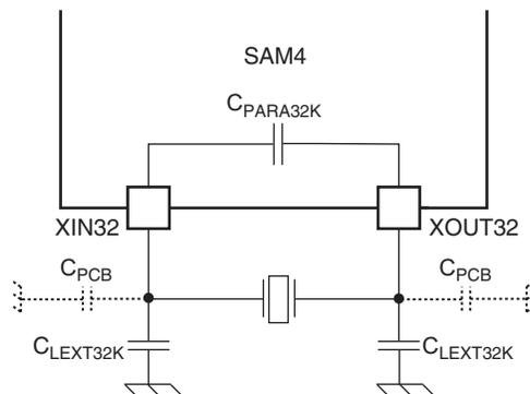
$$C_{LEXT32K} = 2 \times (C_{CRYSTAL} - C_{PARA32K} - C_{PCB} / 2)$$
